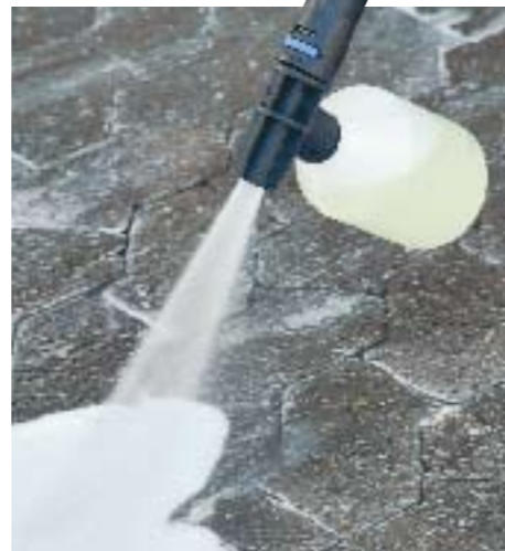
REINIGUNGSVORSÄTZE erlauben ebenfalls eine Vorreinigung mit Zusatzmittel – allerdings nur mit Düsenwechsel
