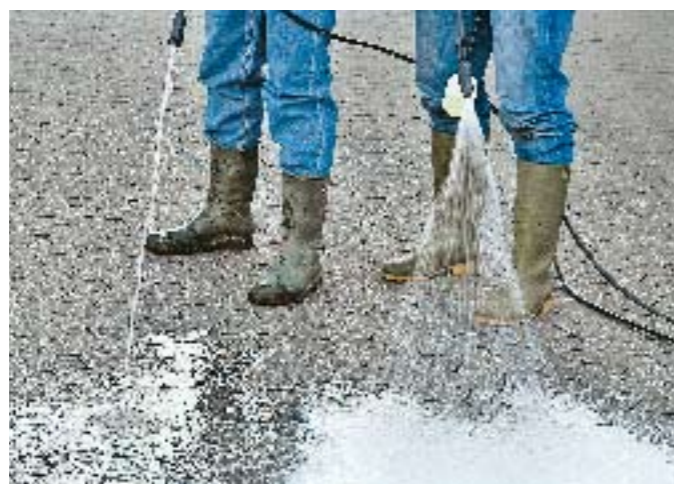
REINIGUNGSMITTEL tragen die Geräte höchst unterschiedlich auf: Das Challenge-Gerät plätschert das Mittel auf die Fläche, bei Stihl wird ein kleiner Schaumteppich erzeugt
