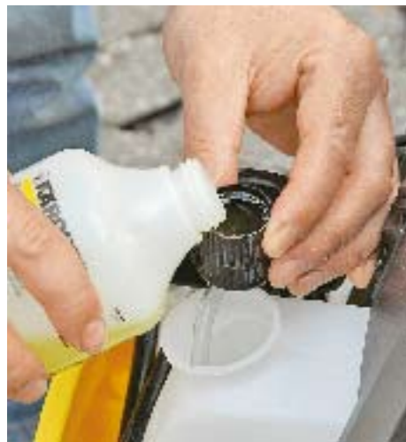
REINIGUNGSMITTEL-TANK: Einige Geräte erlauben die Vorreinigung mit Zusatzmittel aus einem internen Behälter
