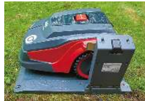
Der Robolinho von AL-KO fährt seitlich in die Ladestation. Dafür braucht er rechts und links einen Meter Platz
