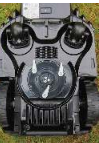
Weit verbreitet: Rotierende Scheiben mit zwei bis vier Messern. Hier: Bosch Indego
