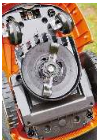
Der Stihl iMow ist mit einem feststehenden und beidseitig geschliffenen Messerbalken ausgerüstet
