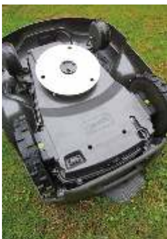
Beim Husqvarna-Mäher werden die Messer im Stillstand eingezogen: Sicher, aber etwas umständlich zu wechseln
