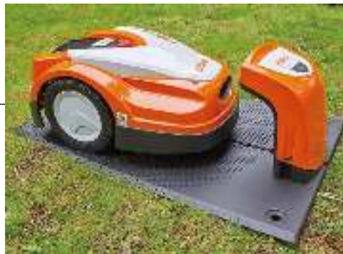
Die meisten Mäher docken vorwärts (im Bild: Stihl iMow) oder rückwärts an der Ladestation an
