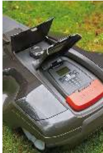
Husqvarna: Schnitthöhenverstellung, Tasten und Display haben einen Schutzdeckel
